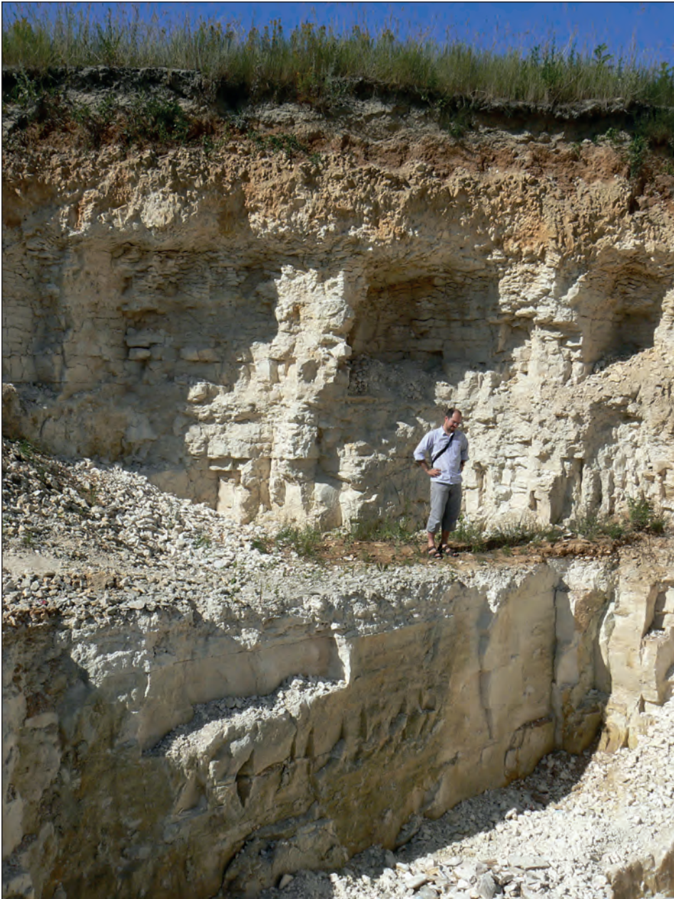
Fot. 1. Łom oksfordzkiego wapienia ooidowego w Nowym Olechowie koło Sienna; widoczny jest całkowity brak izolacji górnourajskiego zbiornika wód podziemnych (na zdjęciu dr hab. Jakub Niedźwiedź), fot. B. Rzonca
