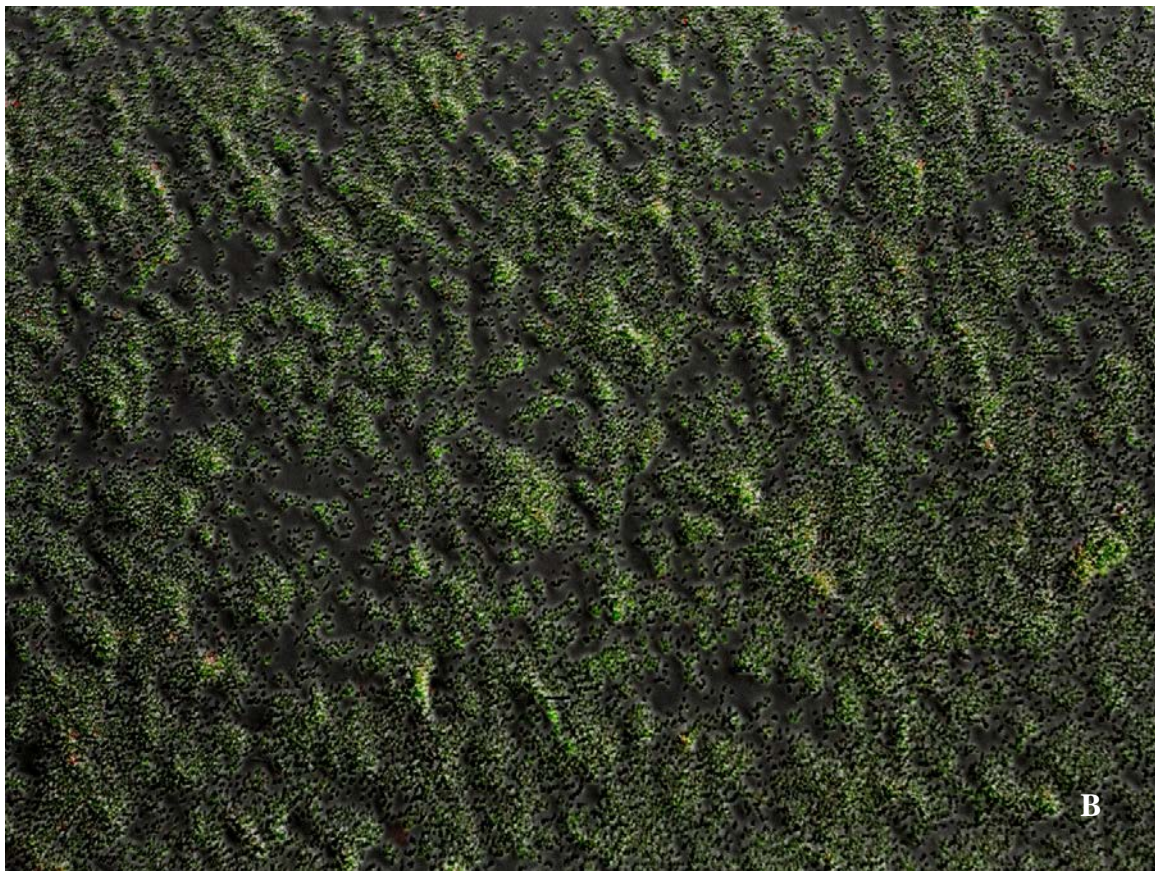
Rys. II.26. Obraz z mikroskopu optycznego (10x50) 24h hodowli bakteryjnej. A. Niezabezpieczone szkło. B. Szkło zabezpieczone 10 biwarstwami filmu CCh/ACh.
