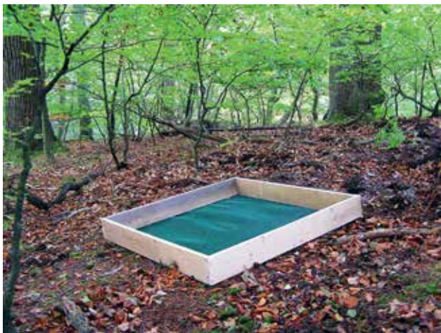
Ryc. 7. Łapacz listowia – przyrząd służący do szacowania rozmiarów opadu podkoronowego w danym czasie w przeliczeniu na jednostkę powierzchni. Fot. P. Dudzik.
