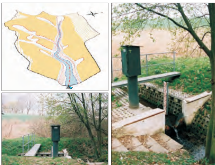
Rycina 12. Metody pomiaru transportu zawiesiny w korycie Dworskiego Potoku – urządzenia pomiarowe (fot. J. Świąchowicz)
