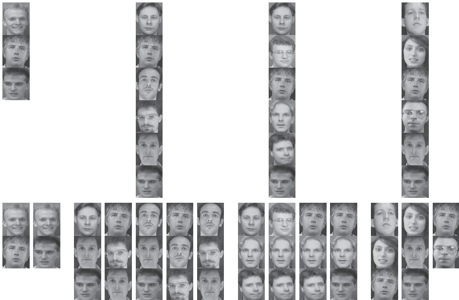
Rysunek 3.7. Część drzewa klastrów w zadaniu rozpoznawania twarzy. U góry klastry pierwszego poziomu. W nauczaniu każda z 40 twarzy była reprezentowana przez pięć z dziesięciu dostępnych zdjęć. Ostatni z klastrów pierwszego poziomu nie został już podzielony. Zdjęcia z bazy AT&T
