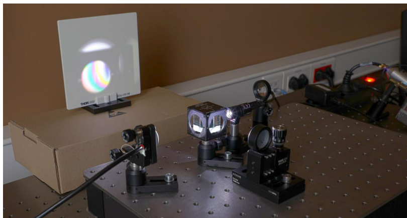
Rys. 7. Interferometr i prążki (dość rozmyte) dla białej diody LED typu RGB o drodze spójności światła około 5\ \mu\text{m} (foto: Krzysztof Magda)
