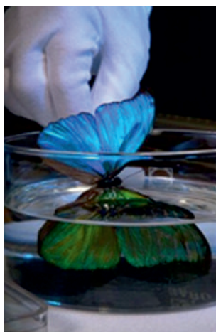
Rys. 6. Zależność barwy strukturalnej od rodzaju ośrodka, w którym znajduje się obserwowany przedmiot
