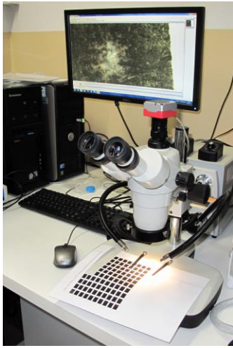
Rys. 15. Urządzenia wykorzystywane do obserwacji badanych próbek: a) mikroskop stereoskopowy, wyposażony w kolorową kamerę, b) „docu-scope” do obserwacji obiektów w świetle IR oraz UV.
