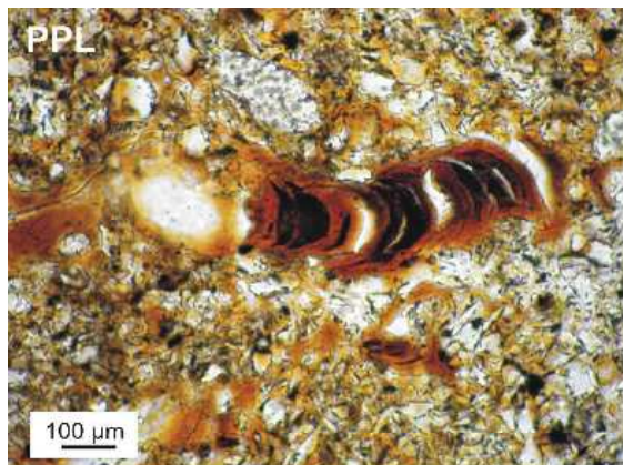
G. Mikrolaminowane wypełnienie ilaste przesycone związkami żelaza, profil Łazy 2, poziom Btx2.
