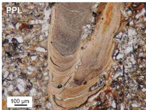
K. Mikrolaminowane wypełnienie ilaste o zróżnicowanym uziarnieniu lamin, profil Brzezie, poziom Btx.
